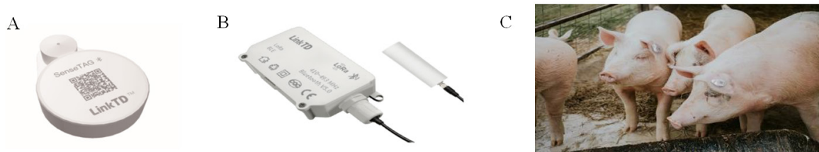
图 1 生猪行为监测实例 Fig. 1 Demonstration of pig behavior monitoring (A : 智能耳标 ; B : 数据汇聚网关 ; C : 安装现场)
